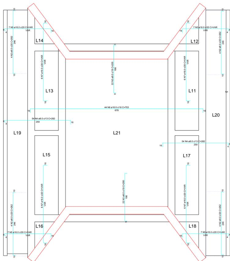
Armação negativa das lajes do pavimento 01 TABULEIRO
