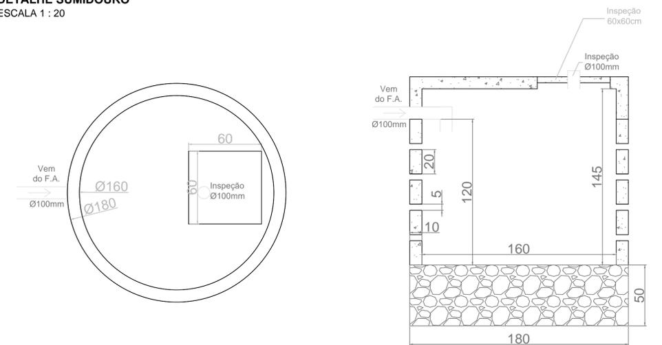
**DETALHE TANQUE SÉPTICO**
