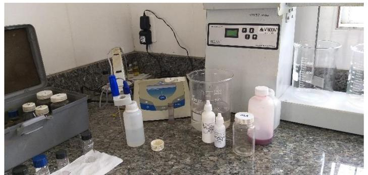
Figura 28: Laboratório – Analisadores de parâmetros (pHmetro, clorímetro e colorímetro).
